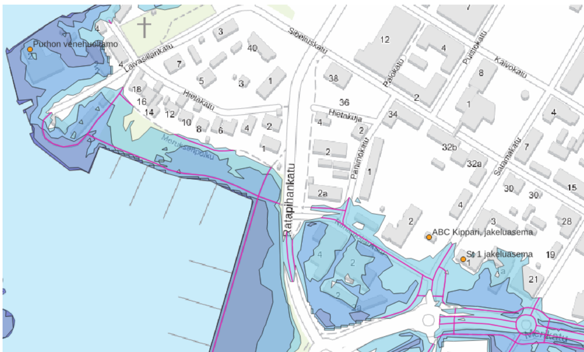
Kuva 18. Meritulvavaara-alueelle sijoittuvat kadut, polttoaineiden jakelupisteet ja varastot.
